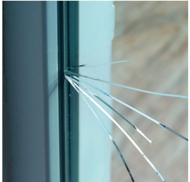
Der rechtwinklige Verlauf des Einlaufs von der Glaskante ist charakteristisch für ein Bruchbild aufgrund thermischer Belastung.
